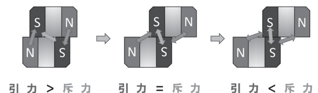
図8 短軸方向の水平的ずれに応じた2つの磁石構造体の間に働く磁力
