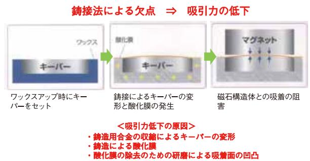
図14. キーパー固定はKB法と鋳接法の2種類から選択可能(鋳接法の欠点)
