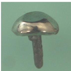
図13- 1. 鋳造用磁性合金根面板 (0.927gw)
