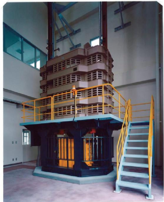
図8. ダブル LIM を用いた制動装置<sup>8)</sup>
