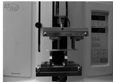
図 4. 小型卓上試験機および試験体 (変則四点曲げ試験)
