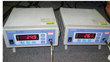
図11. 蛍光ファイバー式温度計 (FL-2000)
