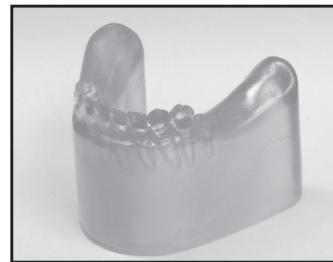
図2. 光弾性実験モデル
